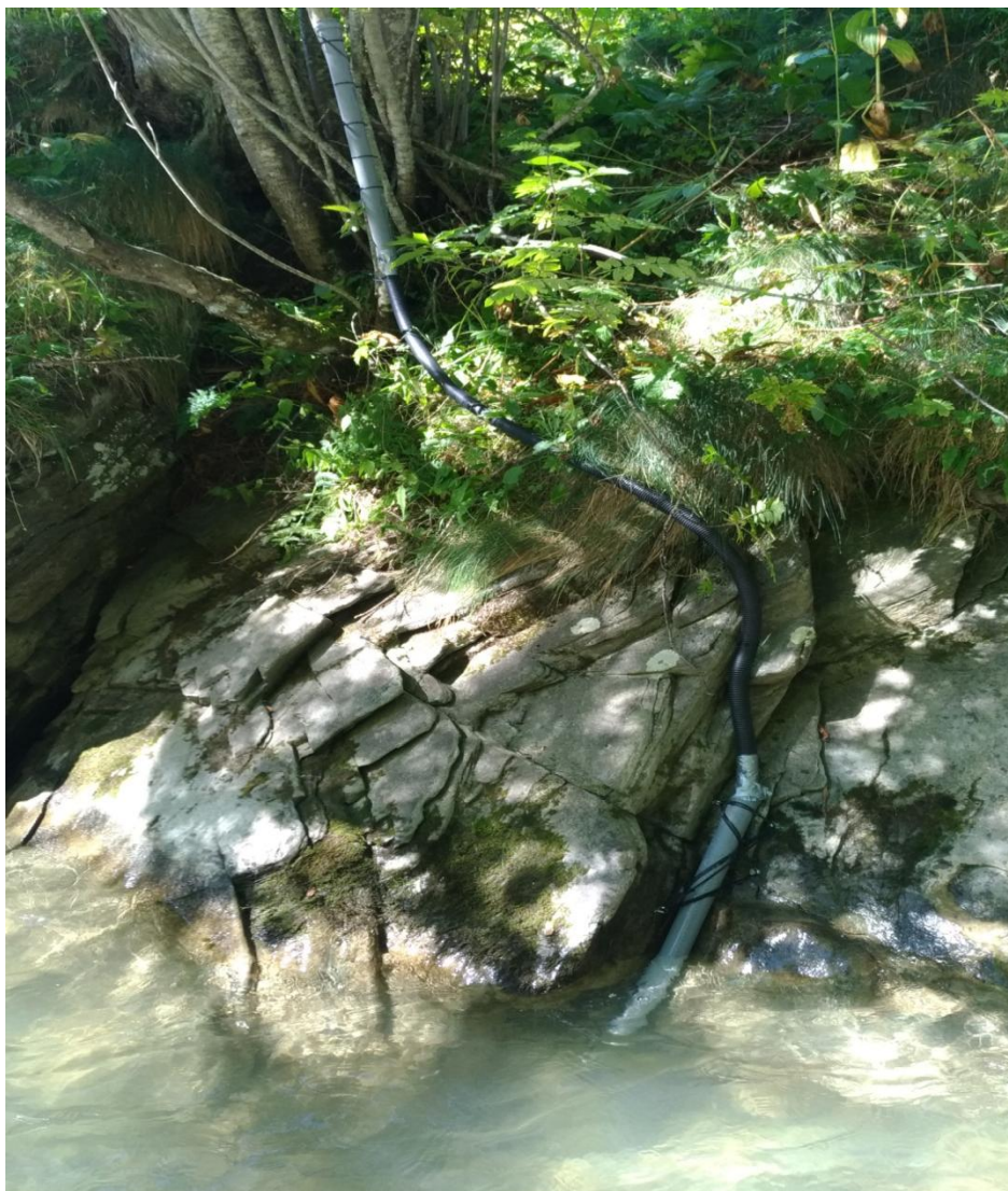
Figura 6: stazione di misurazione delle portate in continuo.
